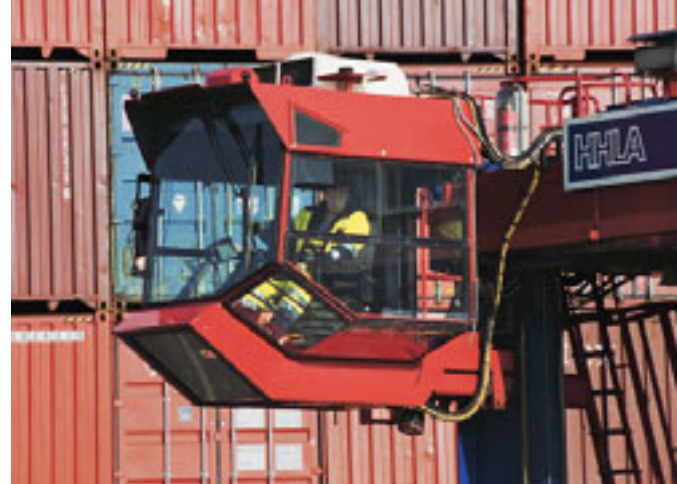
Fahrerkanzel in 12 Meter Höhe: Van-Carrier im Einsatz.
